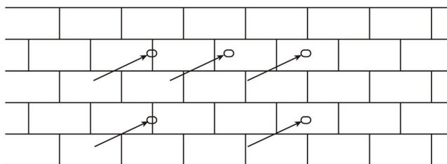
Inserte los tubos de expansión en los agujeros y apriételes. Instale el soporte con los tornillos de expansión.
